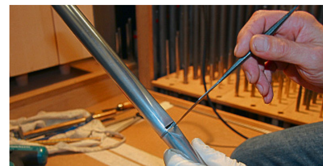
Mit verschiedenen Werkzeugen, darunter auch Stechseisen, werden die Fußlöcher der Pfeifen bearbeitet.
